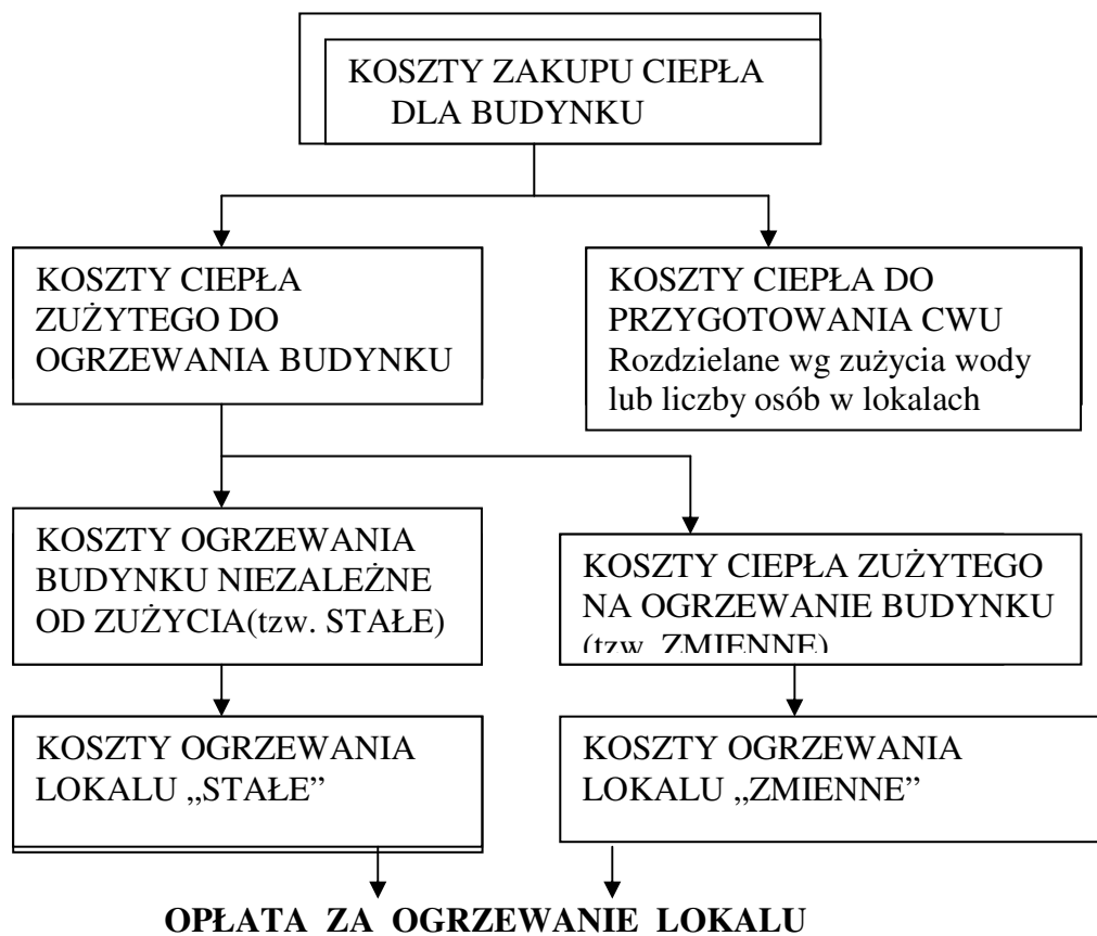
Rys. 3. SCHEMAT ROZLICZENIA KOSZTÓW CIEPŁA W BUDYNKU WEDŁUG INDYWIDUALNEGO ZUŻYCIA
